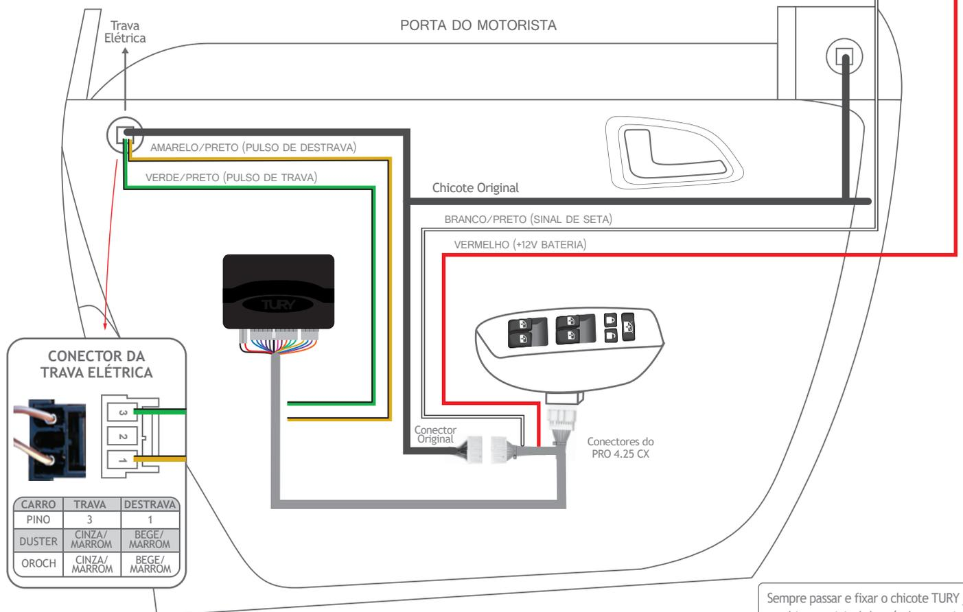
As cores dos fios originais e suas funções e localizações podem variar. Com um multímetro sempre verifique antes de instalar nossos produtos, para evitar possíveis problemas. A TURVY não se responsabiliza por danos causados no sistema elétrico do veículo por falhas de instalação.
